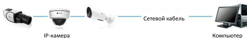
Рисунок 2-1-1. Непосредственное подключение камеры к ПК.
